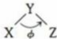
FIGURA 6-5 Dois tipos de vibração molecular interna. Estiramento da ligação (a) é ilustrado para uma molécula diatômica XY . A variável R representa o valor médio da distância X - Y . Em (b), a vibração de deformação angular é mostrada para uma molécula triatômica XYZ . O ângulo médio XYZ é indicado por \phi .
