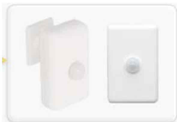
O sensor de presença para comando de iluminação tem como finalidade principal a economia de energia, para isto a sua localização deve ser feita em locais de circulação visto em quanto existe movimento o sensor mantém a lâmpada ligada, e quando cessa o movimento a lâmpada é desligada automaticamente. (ex: escadas, corredores...)
