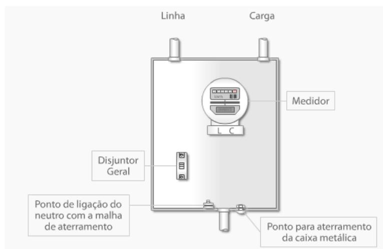
O condutor fase que vem da rede pública é conectado ao disjuntor, e a partir deste segue até o medidor, em seguida o condutor fase segue para a alimentação da rede consumidora. O condutor neutro por sua vez, é ligado a rede de aterramento, e a partir desta é conectado ao medidor, por fim, o neutro segue
