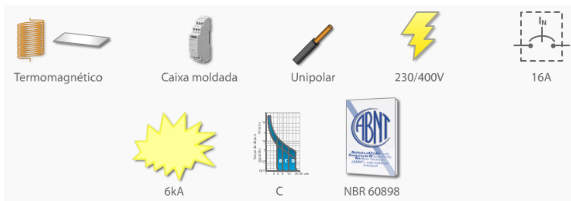
Exemplo 6: Disjuntor termomagnético bipolar
